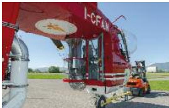
Ein Blick auf die Hilfskontrollstation, in der sich der Operator befindet, wenn der Helikopter für Präzisionsarbeiten eingesetzt wird.
